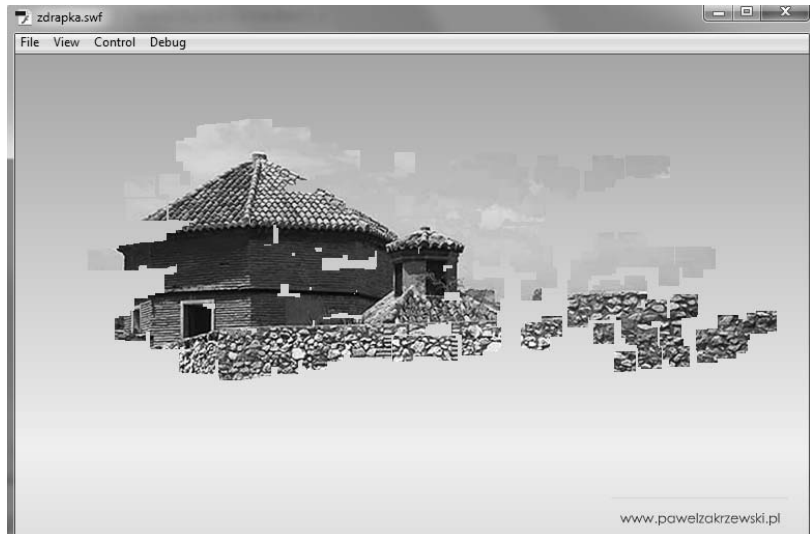
Rysunek 8.30. Aby całość mogła zadziałać, musimy jeszcze określić działanie funkcji malujObraz() . W tym miejscu określamy parametry pędzla — beginBitmapFill() oraz rozpoczynamy rysowanie grafik o dowolnym kształcie wektorowym — drawRect()
