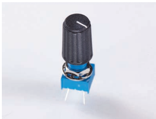
Rysunek 3.10. Potencjometry mogą posłużyć do pomiaru obrotu
