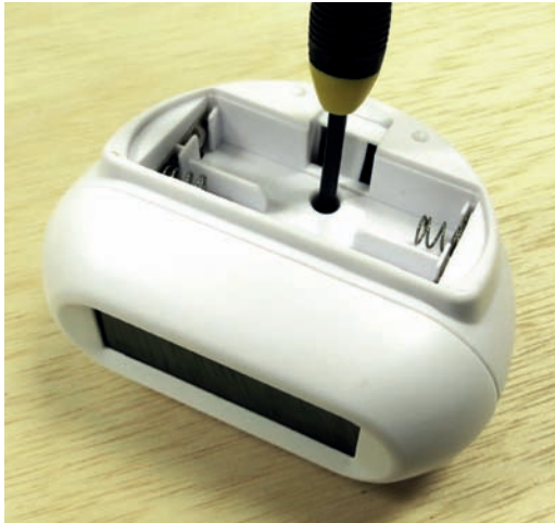
Rysunek 7.6. Obudowa tego zegarka jest skręcona za pomocą tylko jednej śruby ukrytej w zasobniku na baterie
