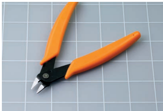
Rysunek 6.4. Cążki pozwalają na pracę tam, gdzie nie sięgną szcypce do cięcia drutu
