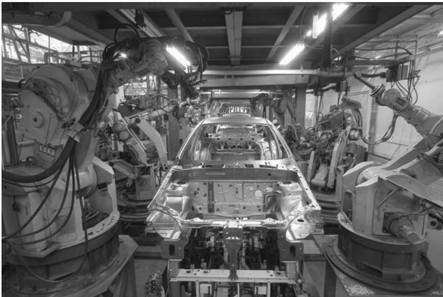
Rysunek 1.3. Roboty na linii montażowej w fabryce samochodów.
