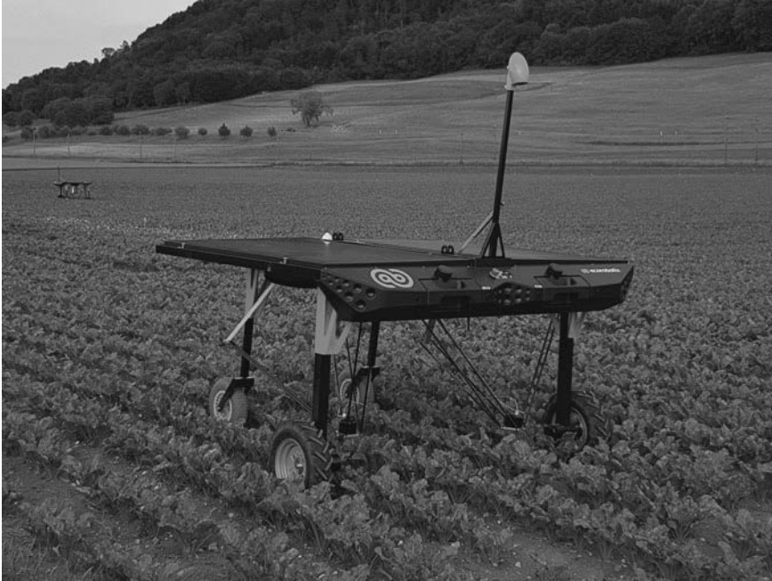
Rysunek 1.4. Autonomiczny robot mobilny do pelenia chwastów (dzięki uprzejmości firmy Ecorobotix)
