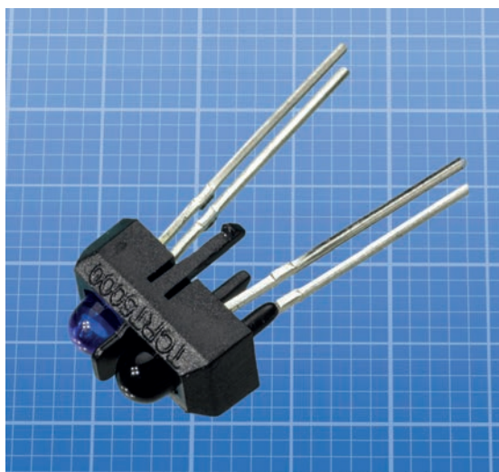
Rysunek 3.9. Czujnik odbiciowy TCRT5000 firmy Vishay. W tle skala milimetrowa
