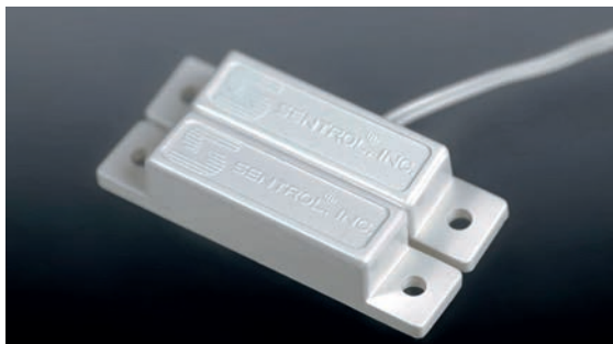
Rysunek 3.12. Typowy zestaw kontaktronowy do sygnalizowania otwartych drzwi lub okna. Na pierwszym planie znajduje się moduł magnesowy, a na drugim — kontaktronowy
