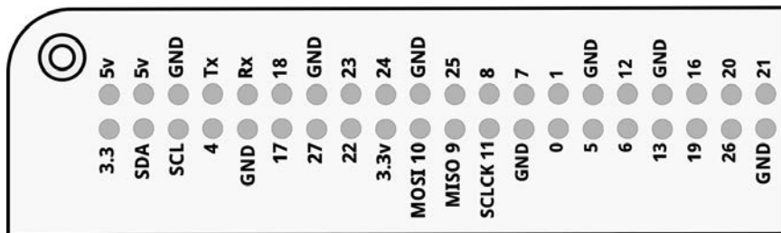
Rysunek 8.14. Piny GPIO Raspberry Pi
