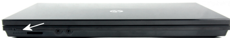
Rysunek 8.23. Sprzętowy wyłącznik bezprzewodowej karty sieciowej
