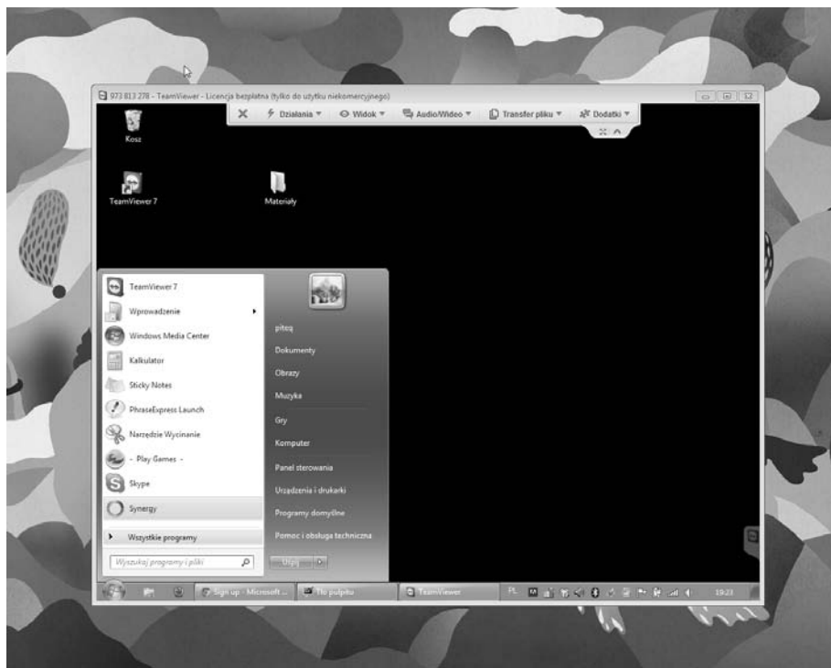
Rysunek 2.20. Otwarte połączenie typu VNC (nawiązane za pośrednictwem programu TeamViewer) pomiędzy komputerem stacjonarnym a laptopem z systemem Windows 7
