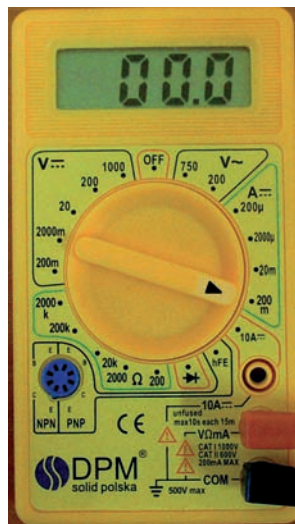
Rysunek 2.29. Pomiar prądu stałego w zakresie do 200 mA
