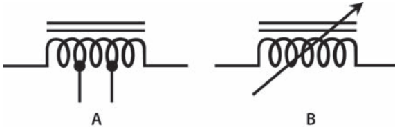
Rysunek 3.21. Symbole cewek o rdzeniu wykonanym z żelaza, które posiadają odczepy (A) lub są regulowane (B)
