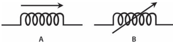
Rysunek 3.17. Symbole cewek powietrznych o zmiennej indukcyjności. Na rysunku A strzałka została umieszczona nad symbolem cewki, a na rysunku B umieszczono ją skośnie na symbolu
