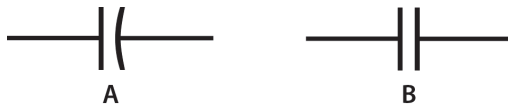
Rysunek 3.10. Alternatywne symbole kondensatorów charakteryzujących się stałą pojemnością; element oznaczony literą A jest kondensatorem spolaryzowanym; w elemencie B w charakterze izolatora zastosowano ciało stałe
