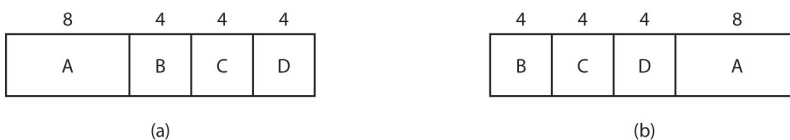
Rysunek 2.19. Przykład algorytmu szeregowania: najpierw krótsze zadania; (a) uruchamianie zadań w kolejności pierwotnej; (b) uruchamianie zadań według zasady „najpierw krótsze zadanie”
