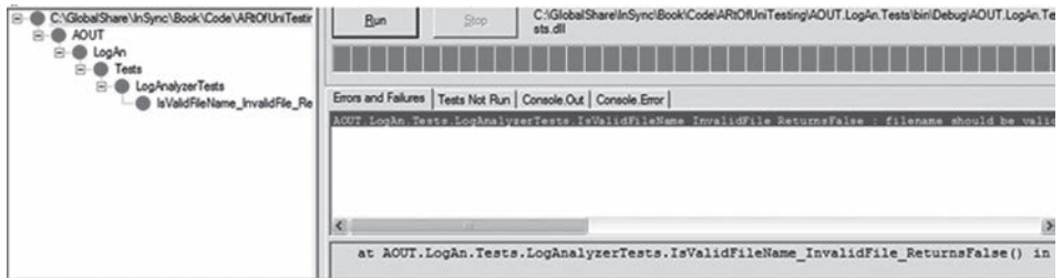
Rysunek 2.3. Niepowodzenie testów NUnit można zaobserwować w trzech miejscach: hierarchia testów po lewej stronie i pasek postępu u góry mają czerwony kolor, a po prawej stronie wyświetlają się komunikaty o błędach
