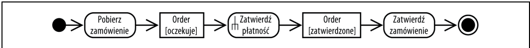
Rysunek 3.18. Ten diagram koncentruje się na opisie zmiany stanu obiektu Order w trakcie procesu zatwierdzania zamówienia
