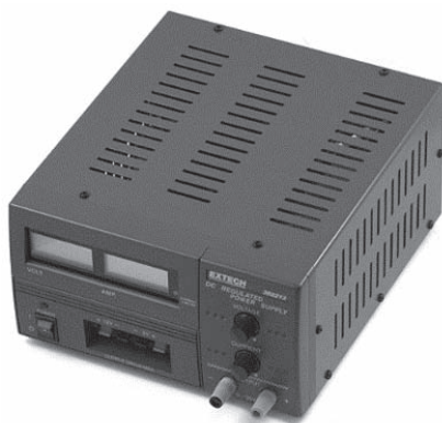
RYСУNEK 5.5. Regulowany zasilacz laboratoryjny (zdjęcie publikowane za pozwoleniem SparkFun Electronics)
