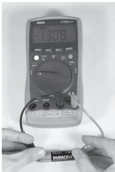
RYSUNEK 5.1. Odczyt napięcia za pomocą miernika cyfrowego
